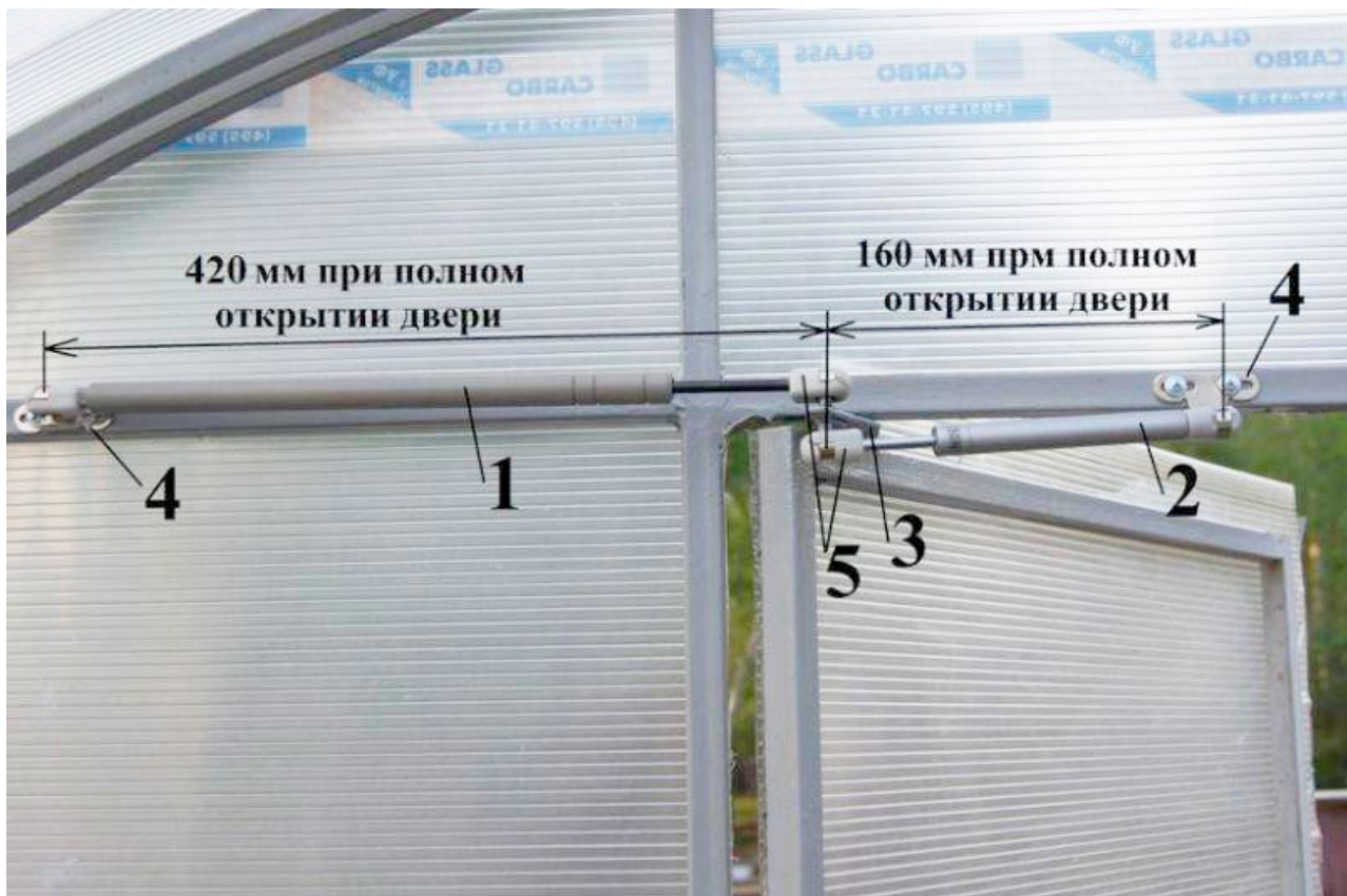
Примеры установки термопривода на дверь или форточку:
