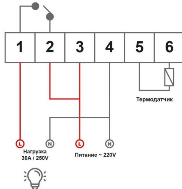
Обратите внимание на перемычку 2-3 клеммы. Выходное напряжение брать с 1 и 4 клеммы
